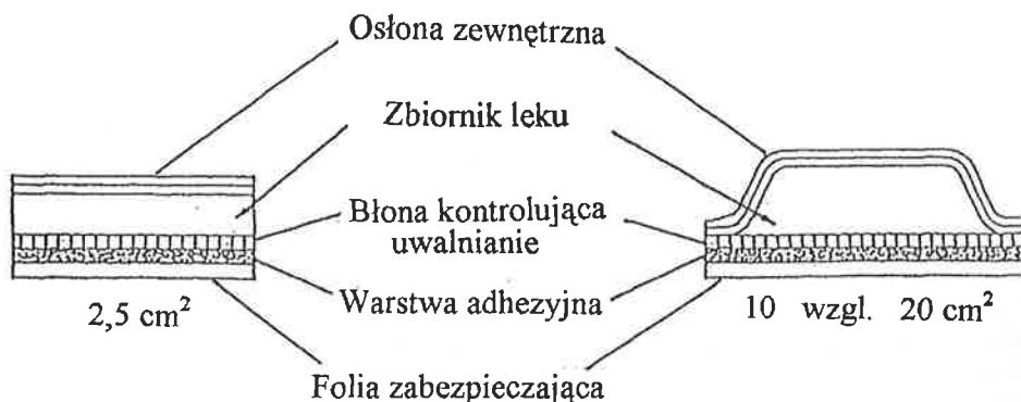
Ryc. 3. Transdermalny system terapeutyczny z błoną sterującą uwalnianiem(6).
